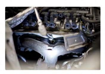
15) Remove turbo heat shield.
